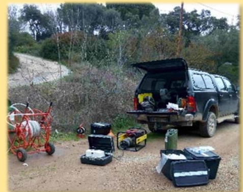
Matériel de terrain pour les prélèvements d'eau
