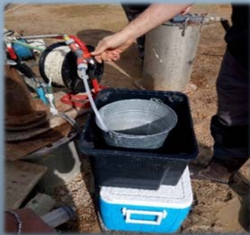
Prélèvement d'eau au forage de Sète
