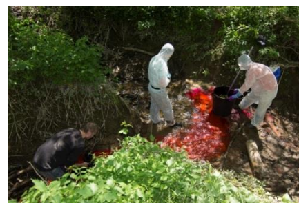
Injection de sulforhodamine au Rébounédou
