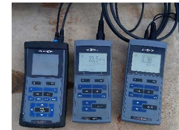
Mesure des paramètres physico-chimiques de l'eau souterraine
