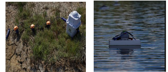
Système d'acquisition à terre et aquatique
