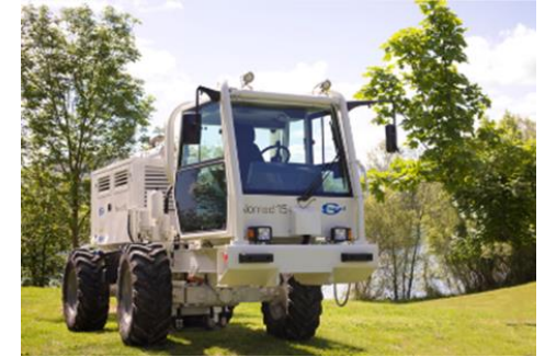
Camion vibreur pour générer des ondes sismique
